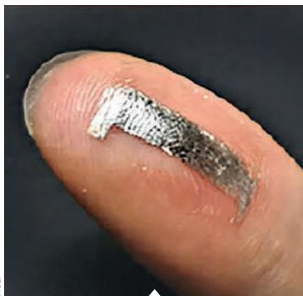
La membrane de polymère recouverte d'argent réagit aux plus petites déformations.
